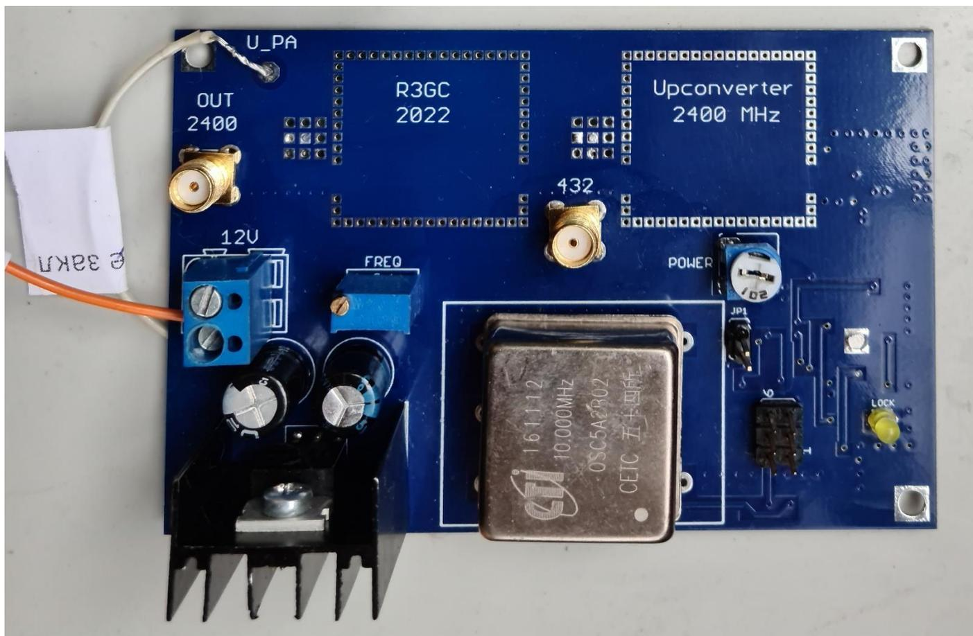
Конвертер преобразует частоту 432 МГц в 2400 МГц с целью проведения радилюбительских связей через искусственный спутник Земли. На вход конвертера с трансивера подается частота 432 МГц мощность менее 2 Вт через кабель RG58 или длиной 10 метров.
