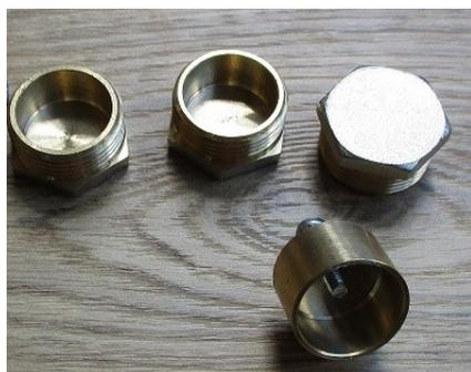
Заглушка должна быть внутри желтого цвета. Внутренняя поверхность гладкая и блестящая. Такие заглушки хорошо паяются. Внутренняя глубина банки после обточки 12.3 мм+0.5мм. Так как стенки тонкие и резьба получается ненадежной, сверху желательно припаять гайку М4. Винты обычные
